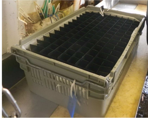
Figure 2: Caisse alvéolée pour le maintien en captivité des langoustines
